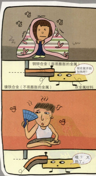
因向下弯曲而断开电源，锅炉停止工作
