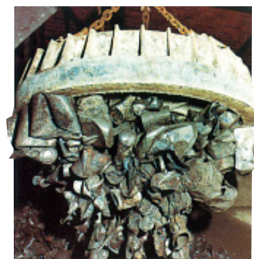
电磁铁被用来对废金属进行分类。
