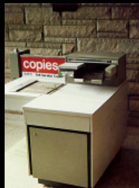
复印机是使用了静电原理的印刷机。
