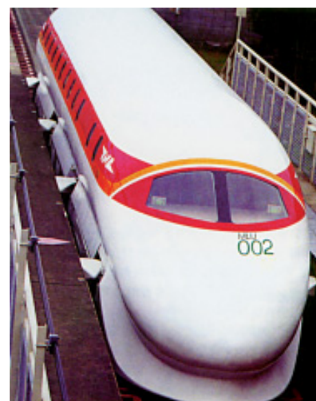
日本新研制的MLU-002磁悬浮列车试车情形。
