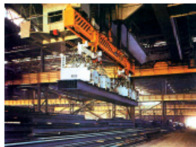
人们利用电磁铁制成运送钢铁的起重机。
