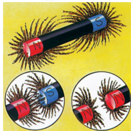
磁铁的磁极示意图
